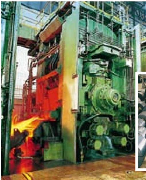
The 6-stand Hot Strip Mill which guarantees strip profile and gauge accuracy of Megasteel's hot rolled coils (inset). Kilang Jalur Panas 6-baris untuk menjamin profil potongan dan mengukur ketepatan lingkaran gegelung besi panas keluaran Megasteel Sdn Bhd (gambar kecil).
